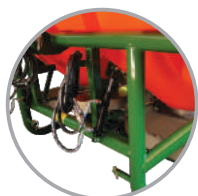
Regulagem de lançamento do produto com comando hidráulico (MQ-1300)
